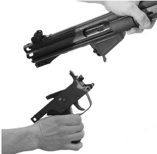
Joonis 12. Püstolikäepide ja päästemehhanismi eemaldamine
