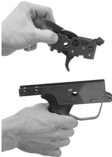
Joonis 13. Löögi- ja päästemehhanismi eemaldamine püstolikäepidemest
