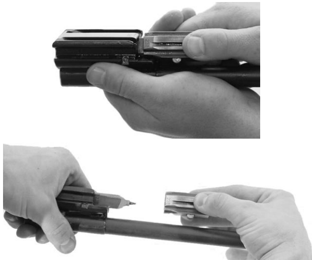
Joonis 15. Lukupea eemaldamine lukuraamist
