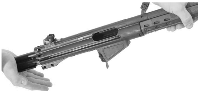
Joonis 14. Lukuraami ja luku eemaldamine vintrauast, lukukojast ja sihtimisseadistest
